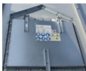
właz dachowy/kąt dachu 30 stopni
