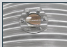
2 OKIENKA REWIZYJNE: W SILOSIE I W LEJU
